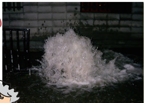
破裂した上水管 [提供:札幌市]
