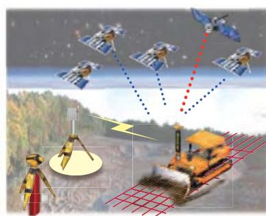
GPS、TSを利用して、建設機械の動作を制御します。
